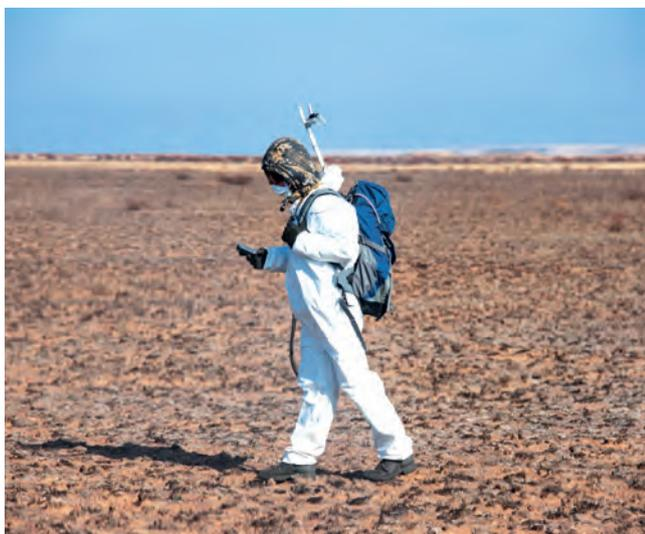
Метод ПГСС позволяет производить обследование территории более оперативно, чем использование in-situ спектрометрии и отбора проб, и детектировать меньшую концентрацию содержания гамма-излучающих радионуклидов в почве, чем аэро- и автогамма-спектрометрическая съемка.
