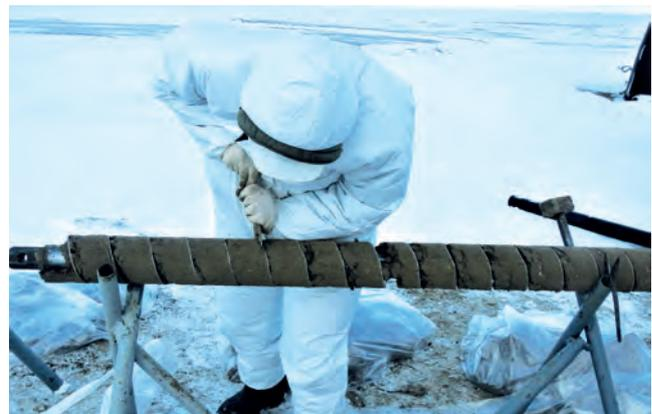
Предварительные измерения и отбор образцов бурового шлама
