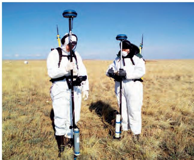
Гамма-спектрометрические измерения по сети  $0,5 \times 0,5$  м
