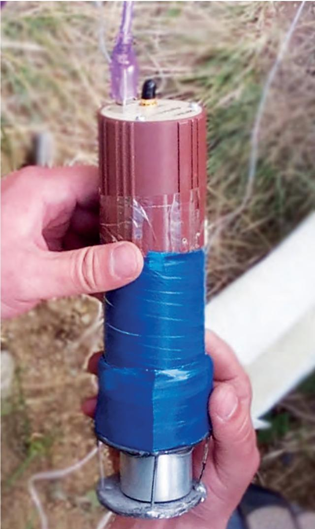
Проведение вертикального и углового гамма-каротажа
