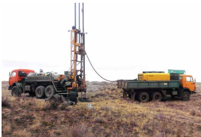
Многоцелевая буровая установка ЛБУ-50 с наличием компрессора КВ-10/10 и бурового насоса НБ-50 предназначена для бурения скважин глубиной до 200 м
