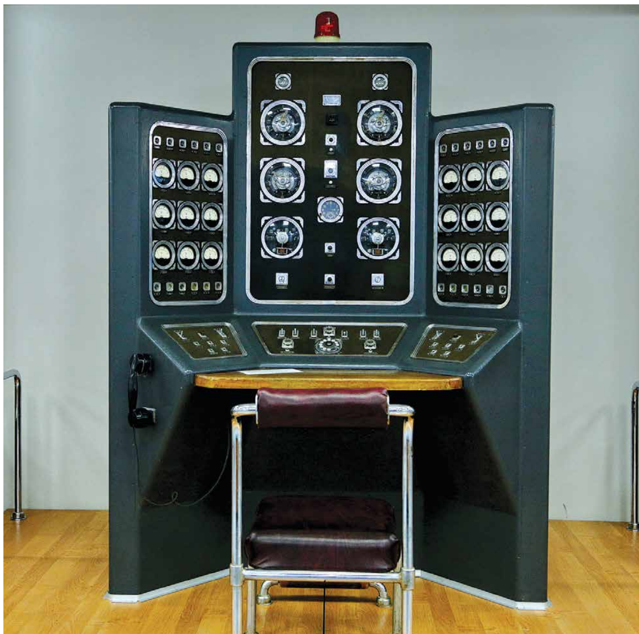
Программный автомат, выдававший сигналы управления на приборные сооружения Опытного поля
