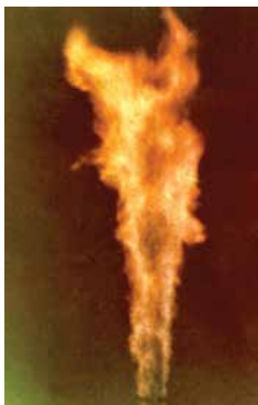
Факел реактора ИВГ.1М на энергопуске 7 марта 1975 года (высота 40 м, расход водорода 4,7 кг/с)
