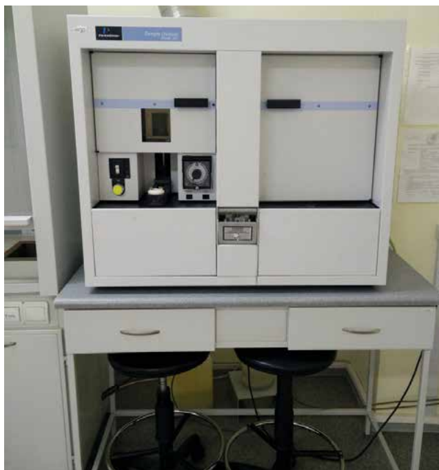
Автоматическая установка для подготовки счетных образцов на определение трития и углерода-14
