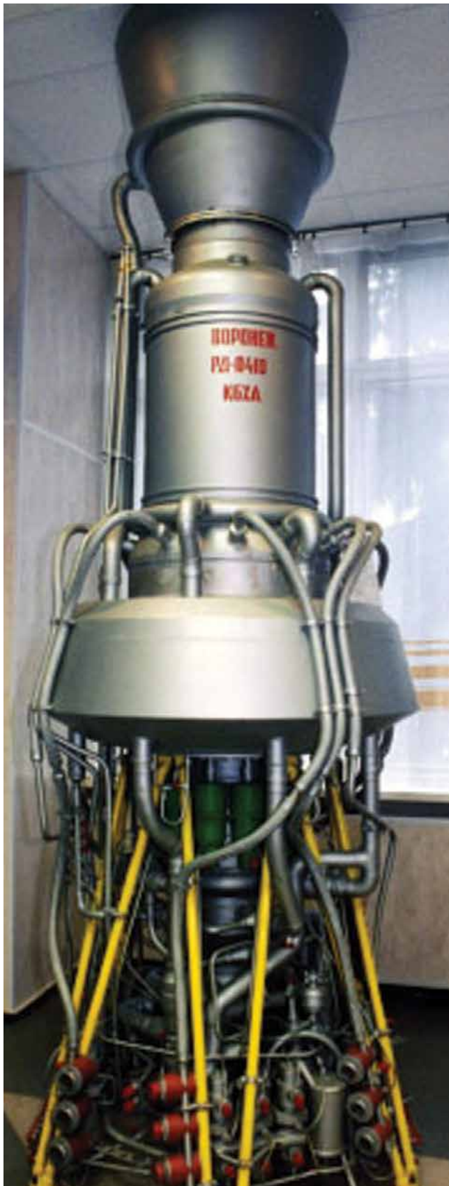
Макет реактора ИРГИТ (11Б91-ИР.100) – стендового прототипа реактора ЯРД
