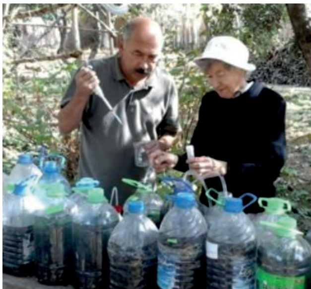
Концентрирование урана из вод на активированном угле в полевых условиях
