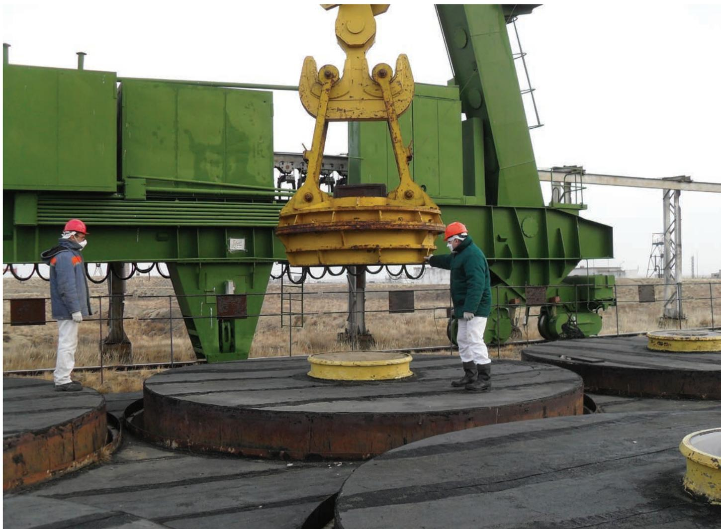
хол; чехол заполняется расчетным количеством ИИИ; на чехол устанавливается крышка и выполнением сплошного сварочного шва обеспечивается его герметизация. После завершения операций в РЗК, чехол при помощи транспортно-технологического оборудования (защитный контейнер, козловой кран) перемещается в хранилище.
