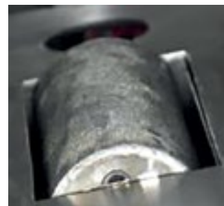
Подвижный модуль дивертора после снятия защитной фольги
