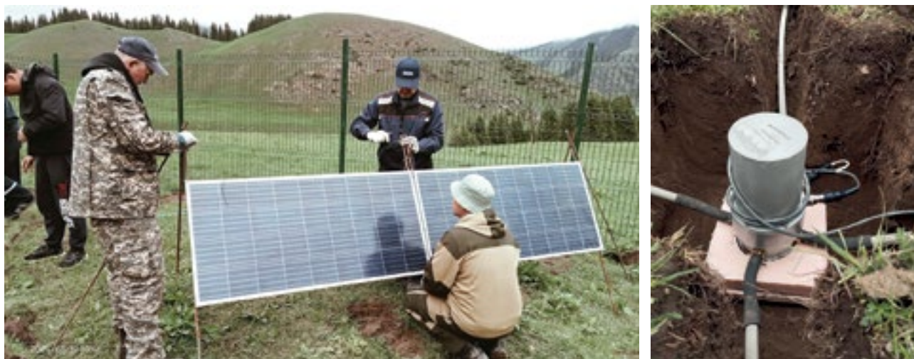
Установка сейсмической и инфразвуковой аппаратуры для исследования ледников
