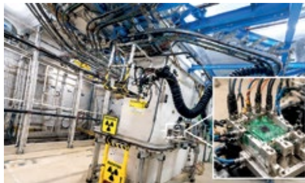
Установка CHARM (CERN) для испытаний электронных компонентов и систем в смешанном радиационном поле. Фото: CERN
