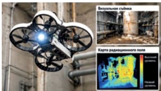
Беспилотная система типа RISER для дистанционного обследования объектов и построения карт радиационного поля
