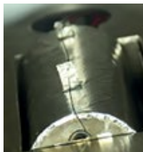
Подвижный модуль дивертора, закрытый защитной фольгой
