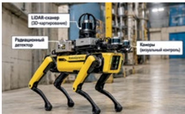
Робот Spot, оснащённый средствами дистанционного обследования радиационно опасных участков. Схематическое изображение на основе примеров применения роботизированных платформ на комплексе Sellafield
