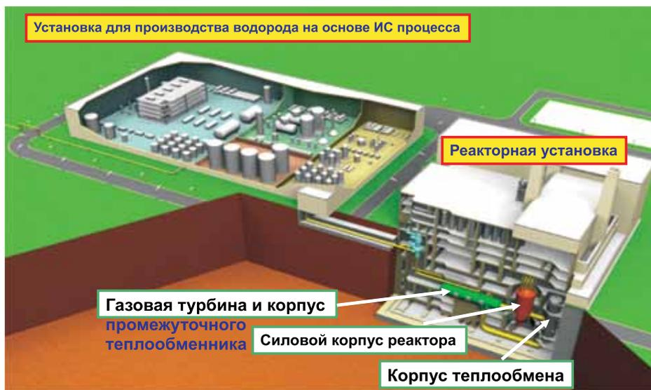
Рис. 15 Станция с реактором типа КВТР
