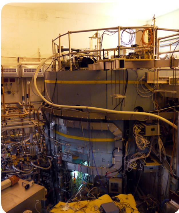
тру тороидальной камеры реактора при помощи магнитного поля, индуцируемого обычно обмотками сверхпроводящих электромагнитов.
