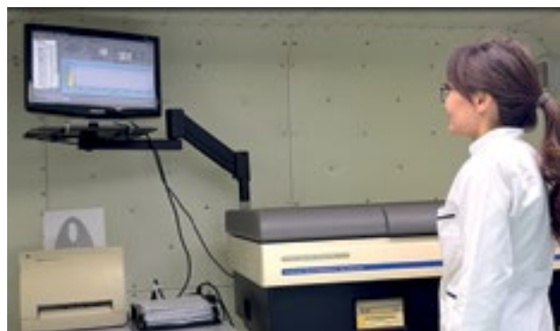
Измерение радиоактивности проб на жидкостном сцинтилляционном анализаторе
