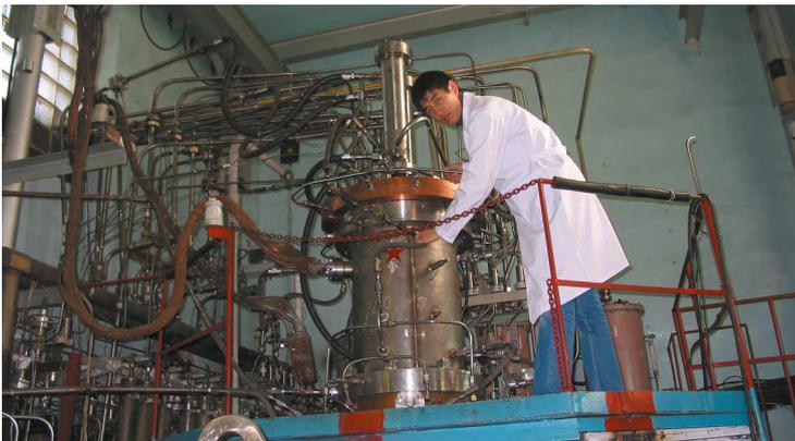
Проверка собранной установки на герметичность
