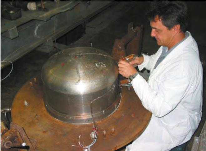
Установка термодпары на модель днища корпуса реактора
