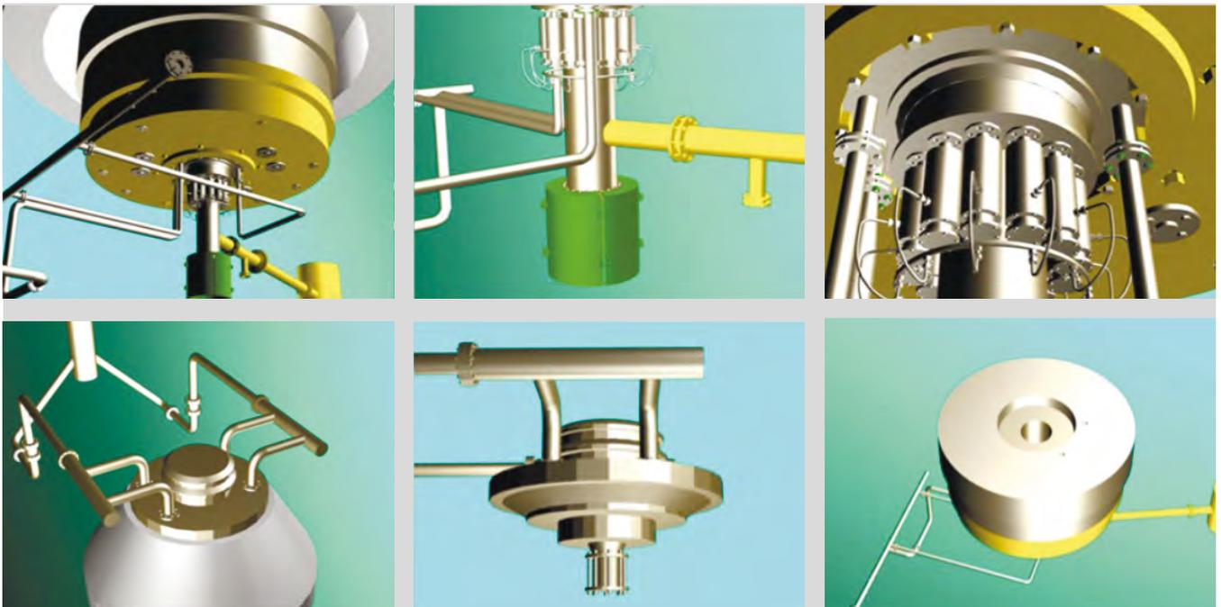
Изображения 3D-модели реактора РА на разных этапах демонтажа
