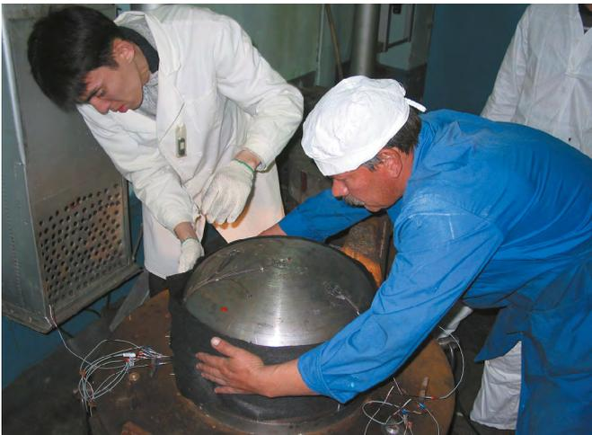
Установка теплоизоляционного кожуха на внешней поверхности модели днища корпуса реактора
