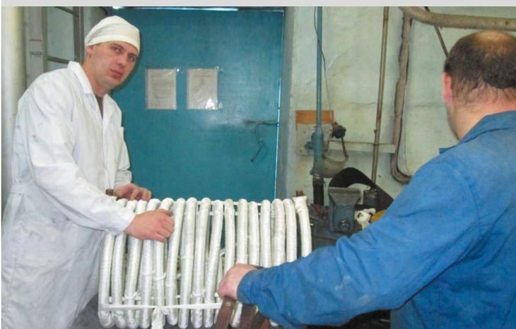
Подготовка индуктора ЭПП к работе. Намотка двухслойной электроизоляции на индуктор ЭПП.
