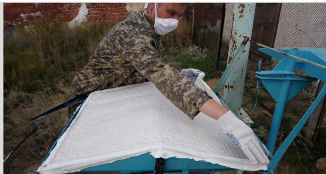
Отбор проб воздушных аэрозолей на стационарных постах мониторинга воздуха
