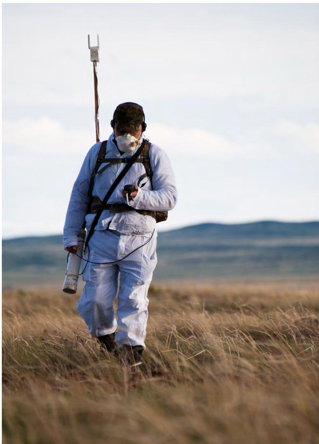
Проведение пешеходной гамма-спектрометрической съемки
