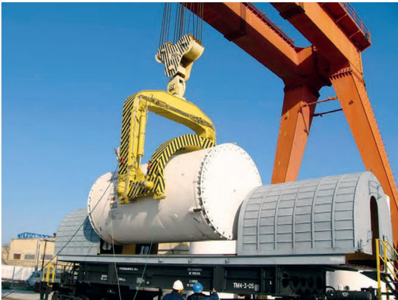
*Погрузка ТУК-123 на ж/д транспортер ТМ 4-3 с помощью козлового крана на площадке временного хранения (ТОО «МАЗК – Казатомпром»)*
