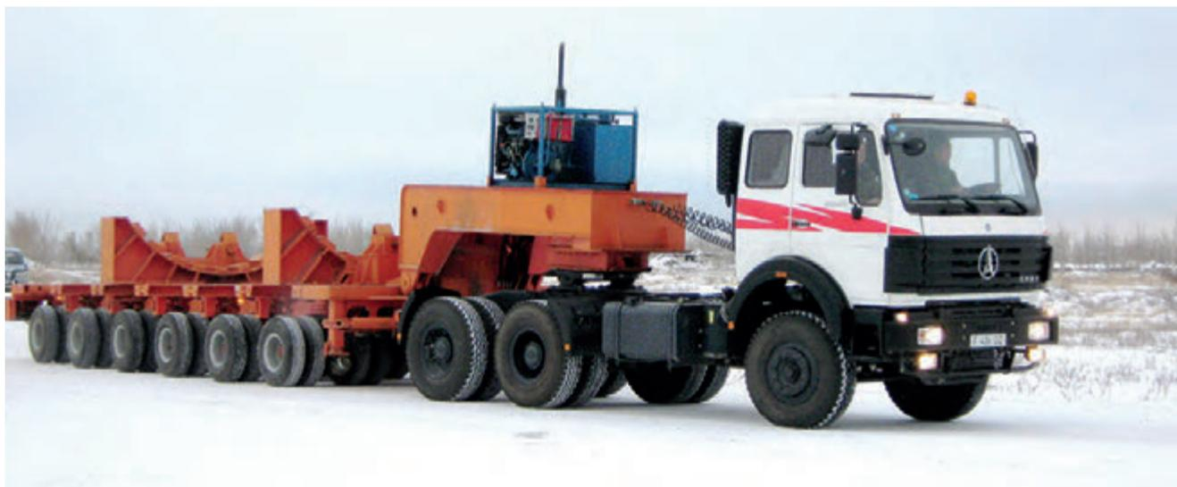
*Автомобильный транспортер с колесным трейлером*
