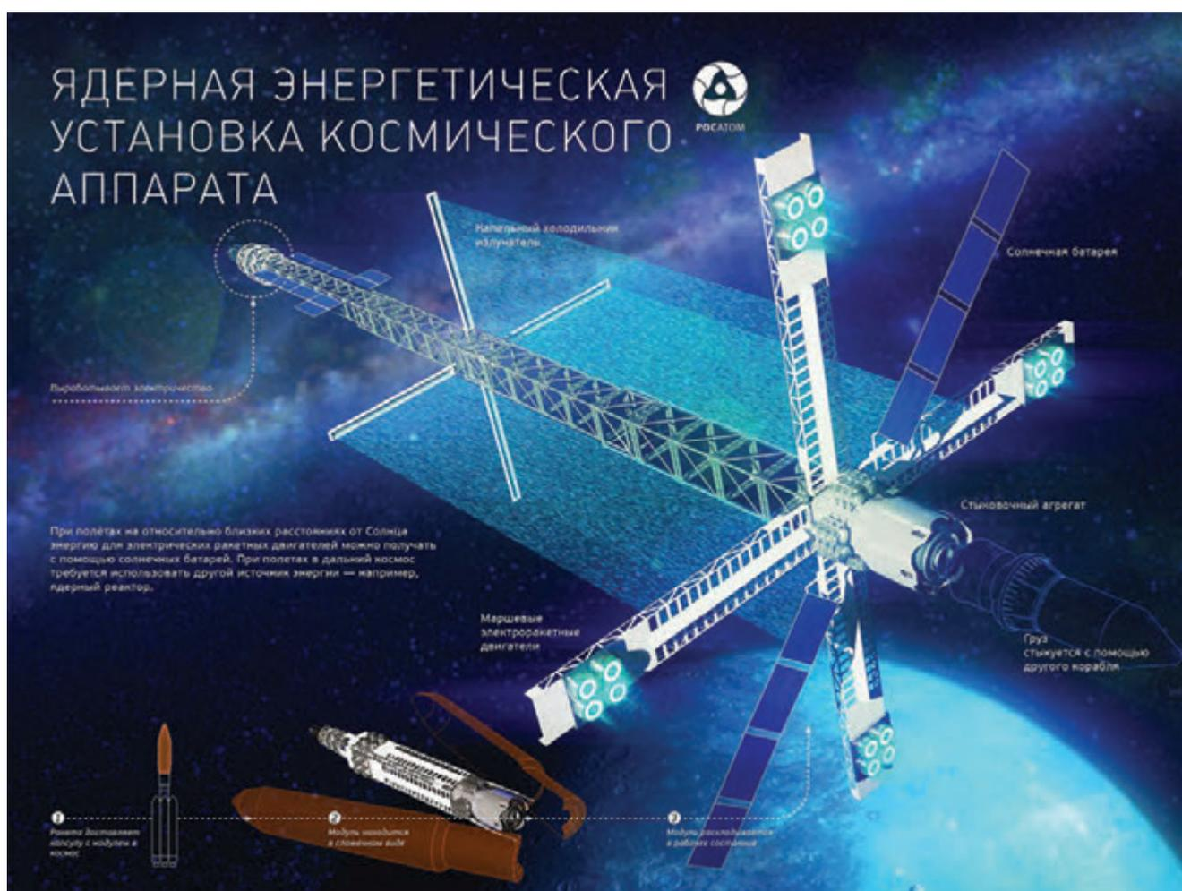
Однако ранее ключевой проблемой в использовании этой установки являлся вопрос охлаждения. Изначально вопрос охлаждения решался путем использования панелей-радиаторов, по которым циркулировала жидкость-теплоноситель. Однако этот метод был не вполне эффективен из-за размеров панели и ее уязвимости для метеоритов.
