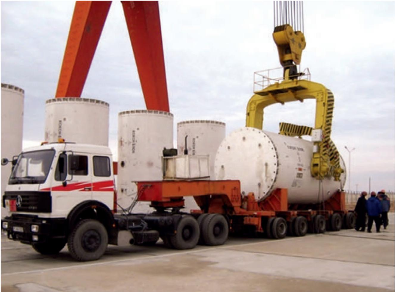
Снятие ТУК -123 с трейлера с применением специальной траверсы
