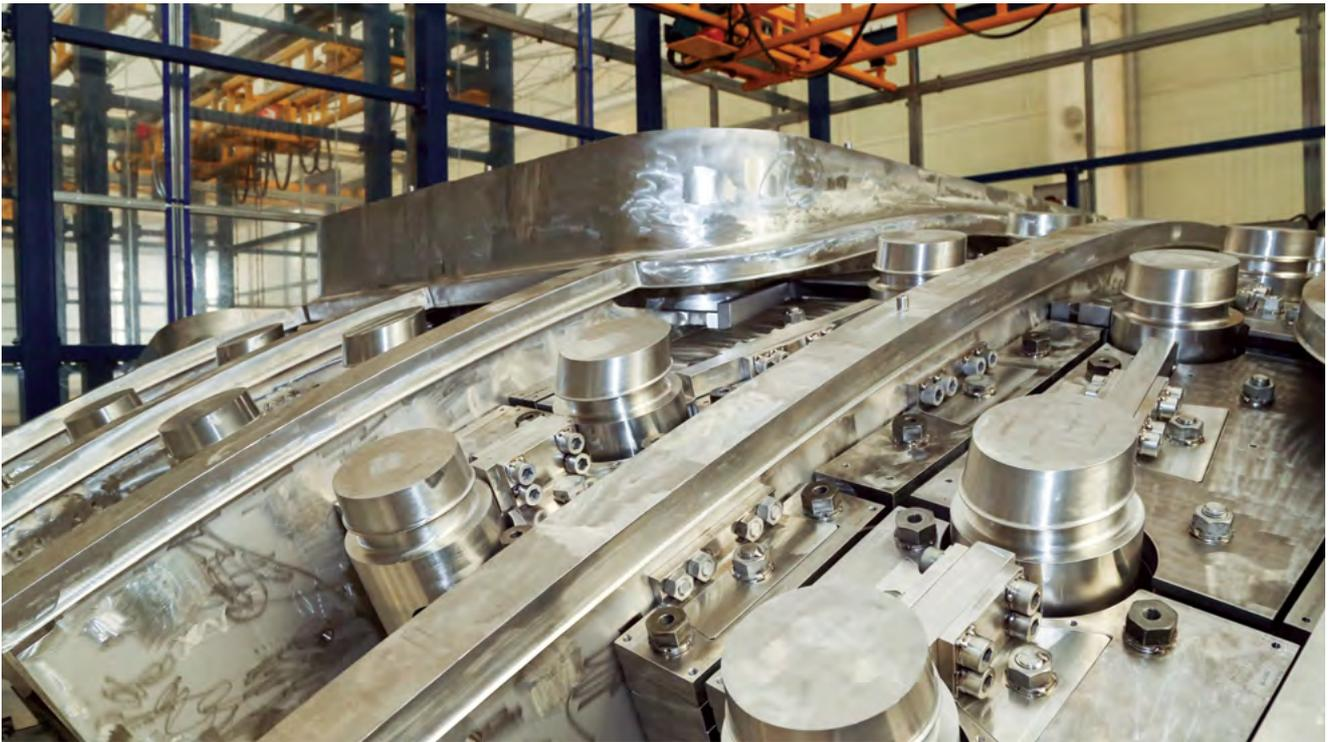
Здесь на вскрытой экваториальной части вакуумной камеры можно увидеть, что внутри между двух стенок уложены стопки стальных листов – из специальной борированной ста-
