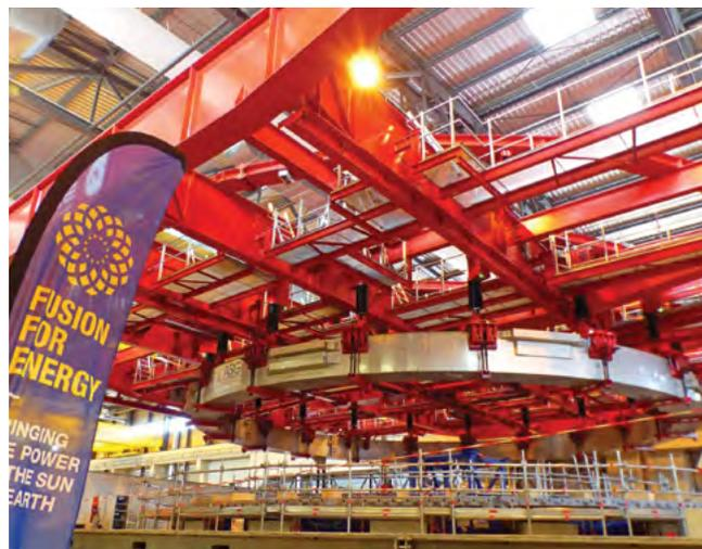
Следующая катушка под монтаж – PF5 в апреле 2020 года прошла предпоследнюю производственную станцию в цехе изготовления полоидальных магнитов прямо на площадке ИТЭР.
