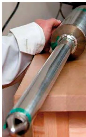
Рисунок 7. Конвертер тепловых нейтронов в нейтроны с энергией 14 МэВ, сконструированный на реакторе MARIA
