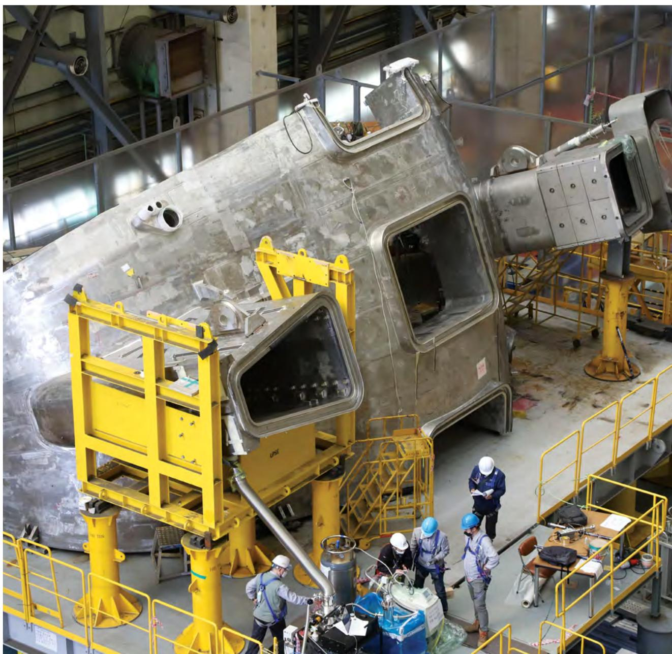
Момент испытаний двухстеночной конструкции сектора вакуумной камеры на плотность
