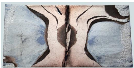
Рисунок 5. Внешний вид поверхности разрушения по бронзовому слою макета ПС
