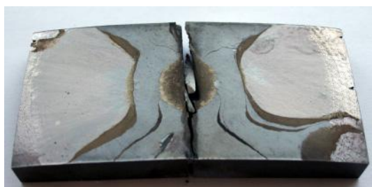
Рисунок 4. Внешний вид поверхности разрушения по бериллиевому слою макета ПС
