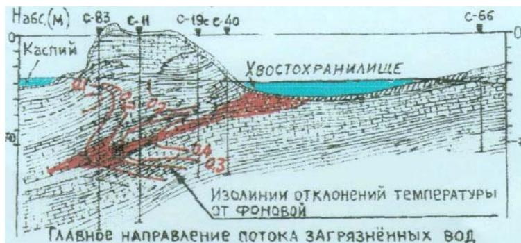
Рис.3. Скважинная режимная термометрия по профилю II (к Рис.2)
