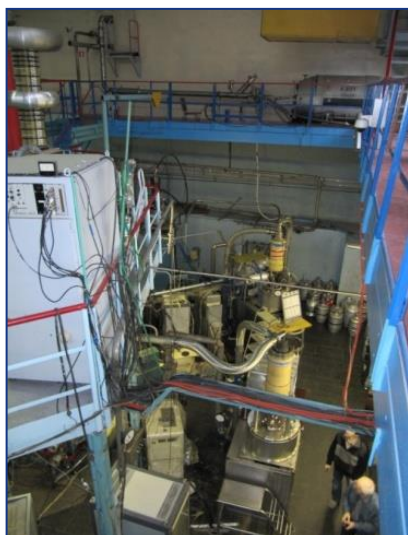
Рисунок 1. Два гиротрона (мощностью 1 МВт каждый), установленные на токамаке Т-10 для ввода СВЧ-мощности в плазму токамака
