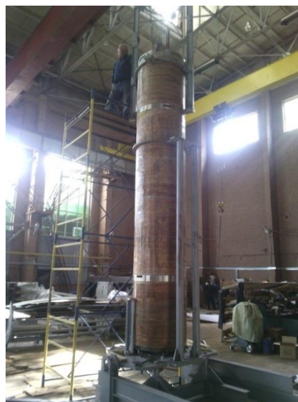
Рисунок 9. Модернизированный Токамак Т-15 с изготовленными элементами электромагнитной системы и вакуумной камеры (слева), центральный соленоид на заводе-изготовителе ООО «НПО «ГКМП» (г. Брянск) (справа)
