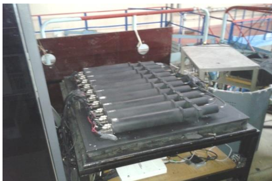
Рисунок 3. Десятиканальная спектральная система
