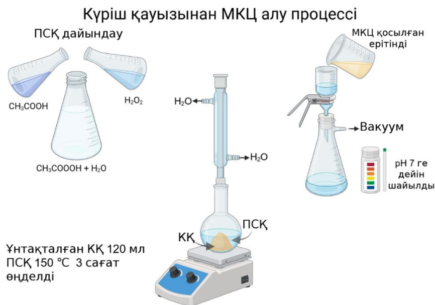
Сурет 2. Биомассаны ПСК-мен өңдеу процесі
