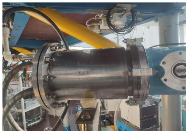
б) изготовленный эквивалент активной нагрузки
