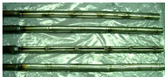
в) жаровые трубы с приваренными инвентарными головками (слева)
