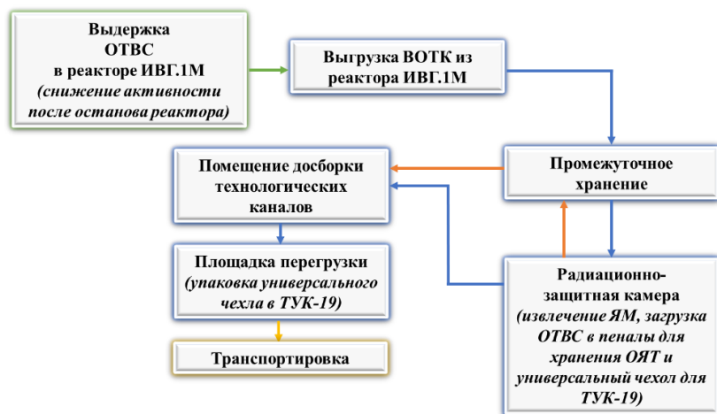
Рисунок 1. Схема транспортно-технологических операций с ОТВС
