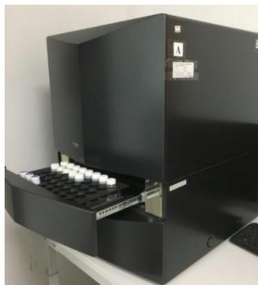
Рисунок 4. Бета-радиометр SL-300
