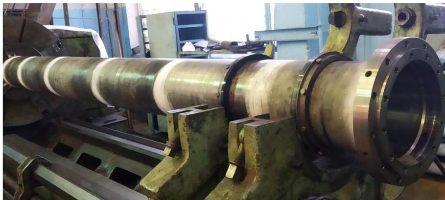
Рисунок 9. Готовая обечайка кожуха наружного
