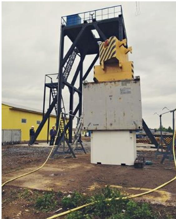
г) Испытание на штабелирование (сжатие с усилием)
