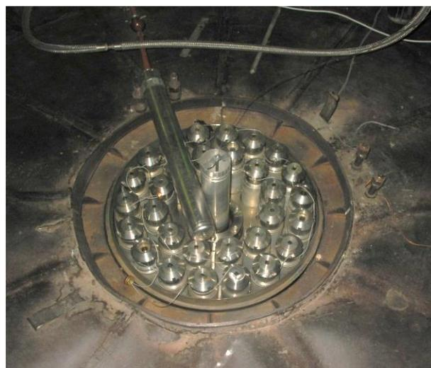
Рисунок 5. Загрузка ЭУ с образцами в реактор для эксперимента
