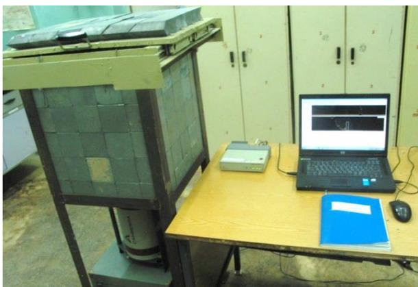
Рисунок 6. Гамма-спектрометрические измерения образцов
