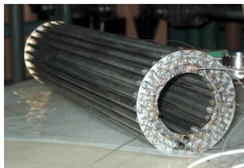
Рисунок 2. Компонировка твэлов в ТВС [9]
