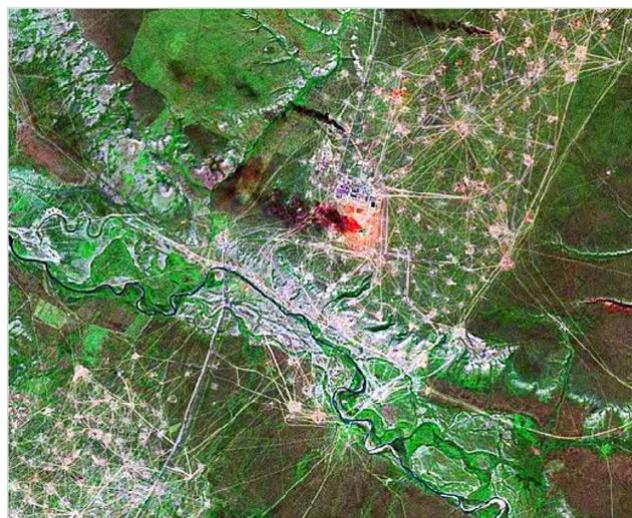
Рисунок 2. Факелы сжигания попутного газа на месторождении Жанажол. Снимок из космоса
