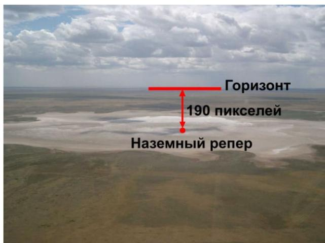
Рисунок 4. Линия горизонта, используемая как опорная для угла нижнего обзора, равного 90°
