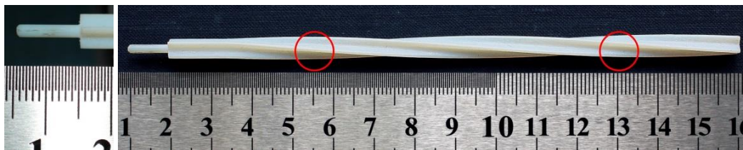
Рисунок 1. Вид макета витого стержня крестового сечения и увеличенное изображение его хвостовика
