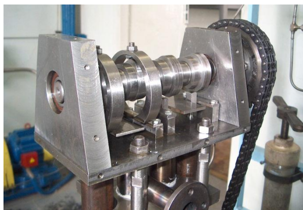
Рисунок 5. Газораспределительный механизм. Крышка снята
