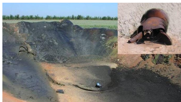
б – Амбар с горизонтальной факельной установкой
