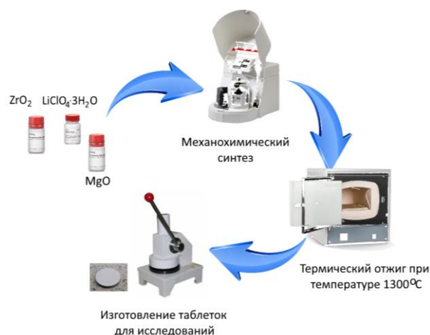
Рисунок 1. Схема получения литийсодержащих керамик
