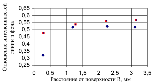
Рисунок 7. Изменение отношения интенсивностей I_{104}/I_f в бестекстурных (синие ромбы) и текстурированных образцах (красные квадраты)
