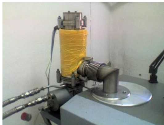
Рисунок 3. Внешний вид криогенного поста, собранного на установке ВУП-5
