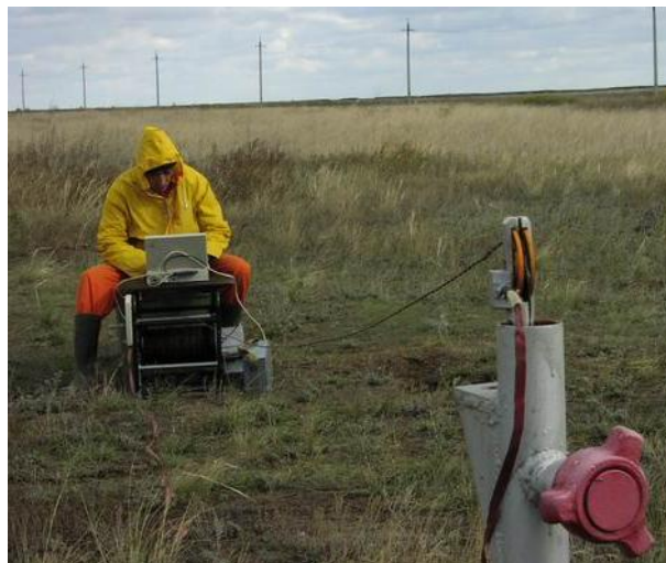
Рисунок 1. Работа на скважине с портативной каротажной станцией (ПКС)
