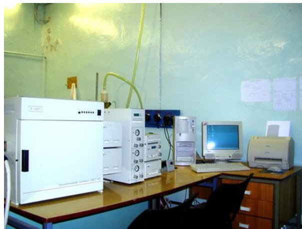
Рисунок 1. Газовый хроматограф "Цвет-800"
