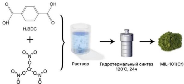
Рисунок 2. Схема получения MIL-101(Cr) гидротермальным методом
