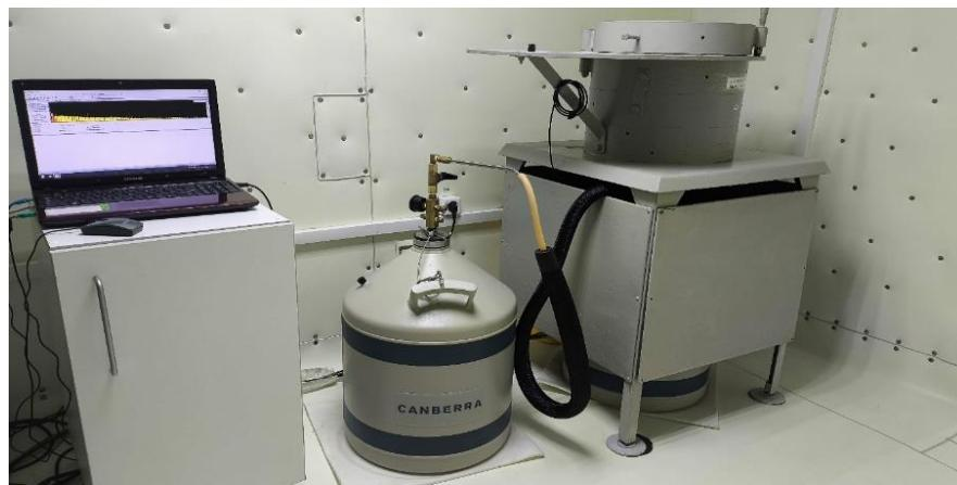
Рисунок 2. Гамма-спектрометрический комплекс с детектором из особо-чистого германия BE3830
