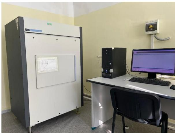
Рисунок 1. Жидкостной сцинтилляционный счетчик альфа-бета-излучения Quantulus 1220
