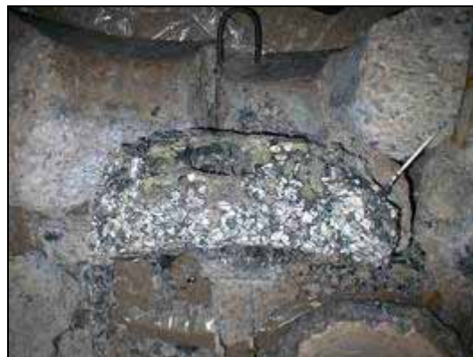
Рисунок 7. Вертикальный разрез верхнего слоя шлака, сформировавшегося в эксперименте D-6
