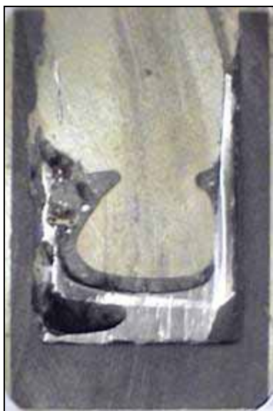
Рисунок 8. Результат плавления диоксида урана
