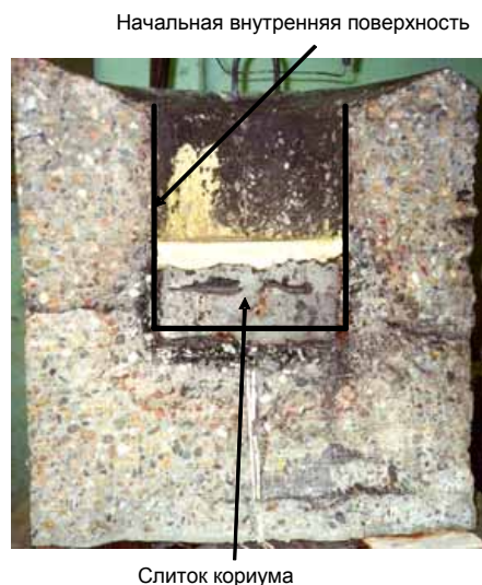
Рисунок 4. Вертикальный разрез ловушки после эксперимента D-8a
