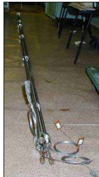
Рисунок 9. Сборка с ампулами для ресурсных испытаний образцов литиевой керамики на реакторе ВВР-К ИЯФ НЯЦ РК
