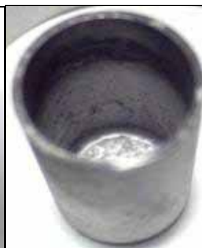
б) Внутренняя поверхность W-вставки
