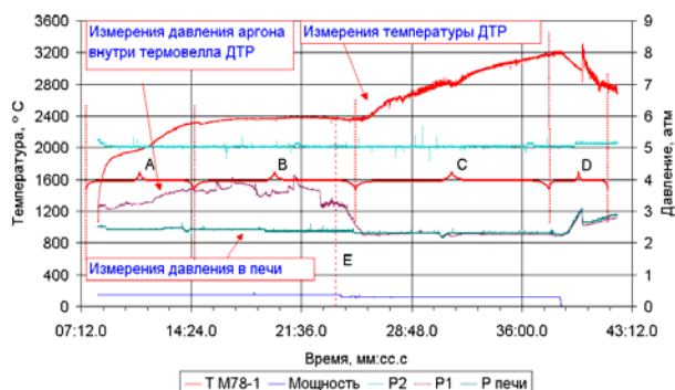
Рисунок 8. Диаграмма измерений температуры в тигле ЭПП на эксперименте UTD-1
