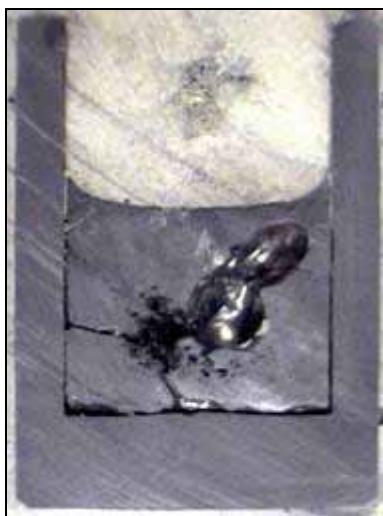
Рисунок 18. Продольный разрез тигля с застывшим расплавом
