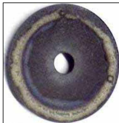
Рисунок 15. Крышка тигля, покрытая цирконием
