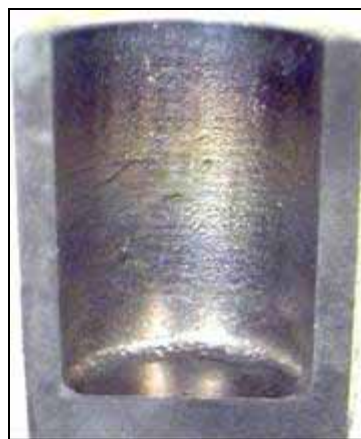
Рисунок 17. Разрез тигля с покрытием
