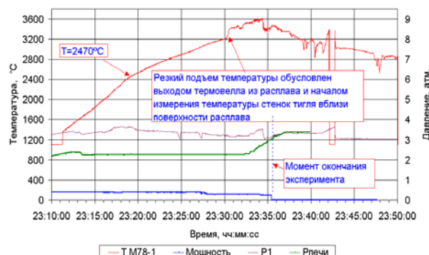
Рисунок 9. Диаграмма измерения температуры в тигле ЭПП с помощью ДТР на эксперименте UTD-3
