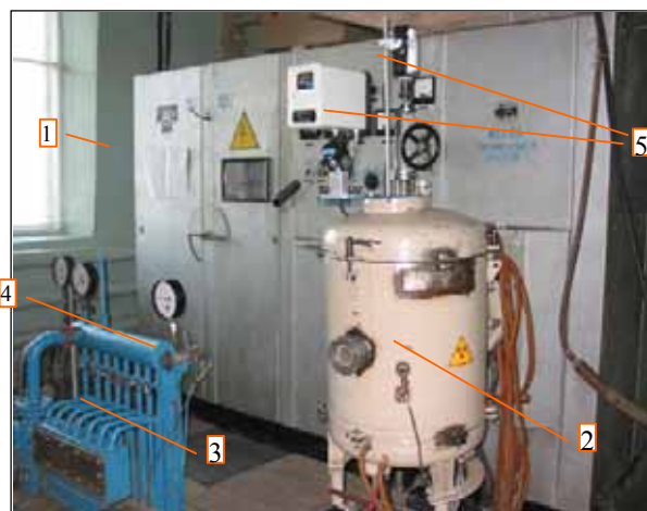
1 – шкаф генератора ВЧГ1-60/0,066; 2 – рабочая камера; 3 – коллектор системы водяного охлаждения; 4 – органы регулирования газовой системы; 5 – пирометры
