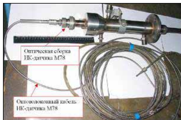
Рисунок 7. Оптическая сборка ИК-датчика M78, присоединенная к монтажному устройству ДТР
