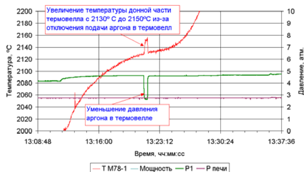
Рисунок 14. Диаграмма измерений температуры ДТР на эксперименте UTD-M3 в развернутом виде
