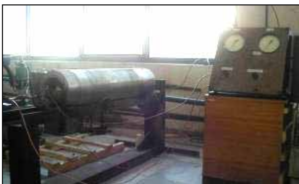
Рисунок 1. Внешний вид генератора импульса давления и характерная форма формируемого импульса давления
