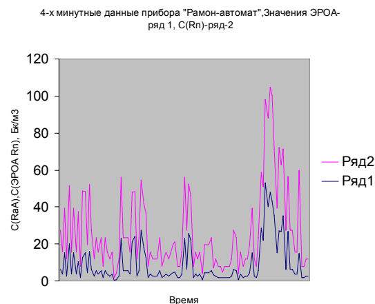
Рисунок 3. Пример автоматического мониторинга ЭРОА радона и объемной активности RaA в комнате панельного здания на 1-м этаже
