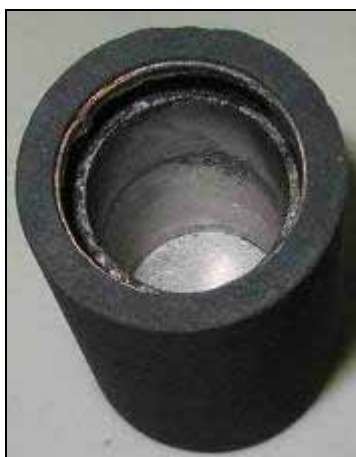
б) Внутренняя поверхность W-вставки
