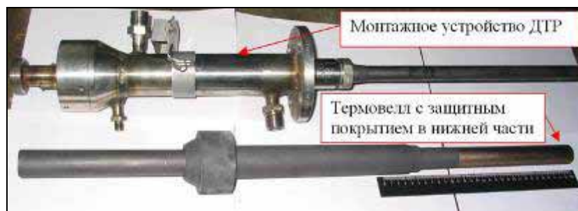
Рисунок 5. ДТР, включая монтажное устройство с фиксированной на нем графитовой трубкой и элементы термовелла и графитового чехла в разобранном виде
