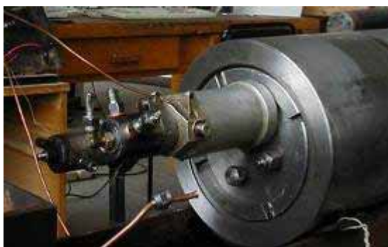
Рисунок 2. Установка датчиков и ИЛ в режиме тарировки и сигнал на выходе гидроусилителя
