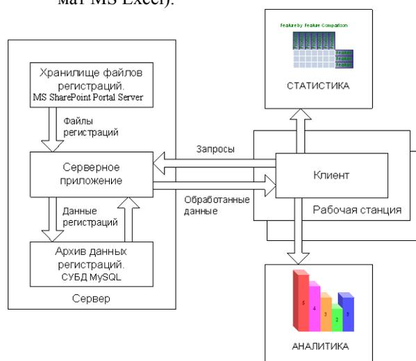
Рисунок 8. Структурная схема системы обработки и предоставления экспериментальных данных
