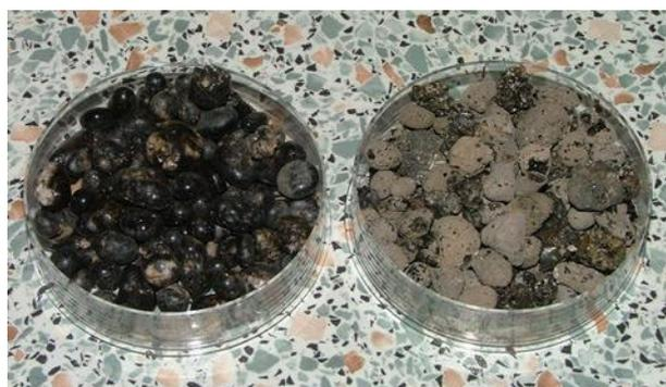
Рисунок 1. Два вида больших «горячих» частиц (размеры более 2 мм), собранных на СИП
