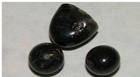
Рисунок 2. Фотография «горячих» частиц, выделенных из фракции 1 ( $f > 1$  мм) образца НР02
