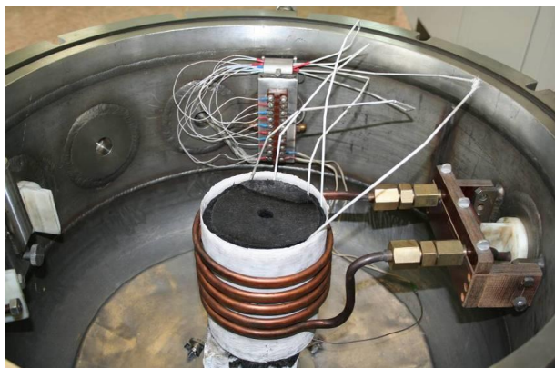
Рисунок 3. Экспериментальная сборка, установленная в индуктор рабочей камеры
