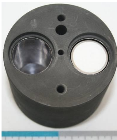
загрузка эталонного вещества ( Y_2O_3 ) в графитовый тигель
