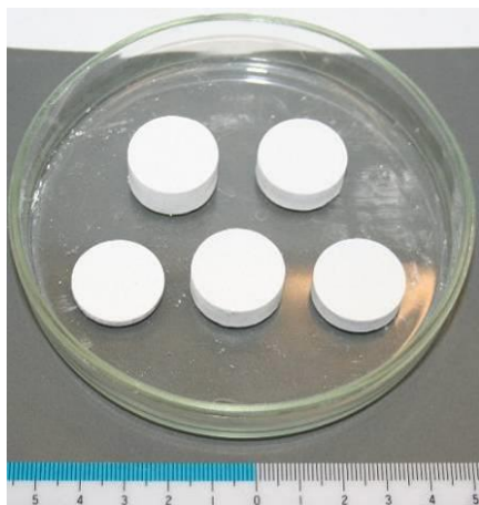
подготовка эталонного вещества (оксида иттрия Y_2O_3 )
