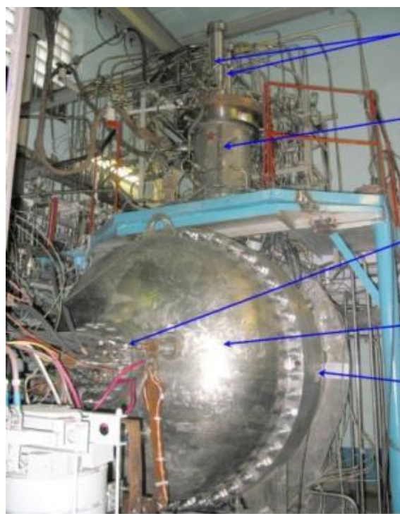
1 – теплообменник ЭПП; 2 – ЭПП; 3 – технологический люк УПР; 4 – съемное основание УПР; 5 – УПР
