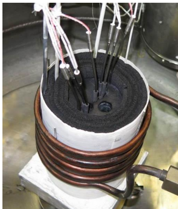
установка экспериментальной сборки в индуктор
