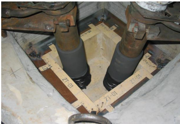
Рисунок 2. Общий вид ловушки расплава с установленными в ней плазмотронами
