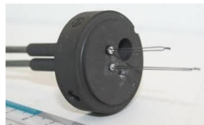
установка термопар в графитовую крышку
