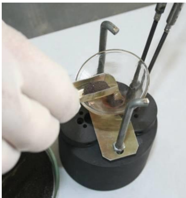
загрузка тигля двуокисью урана
