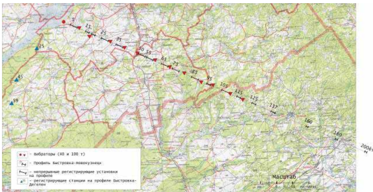
Рисунок 3. Схема наблюдений на вибросейсмическом профиле Быстровка-Новокузнецк
