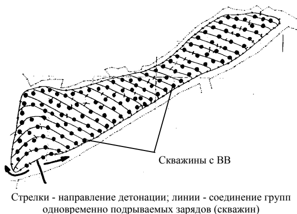
Рисунок 2. Пример расположения скважин в отдельном блоке. Михайловский ГОК
