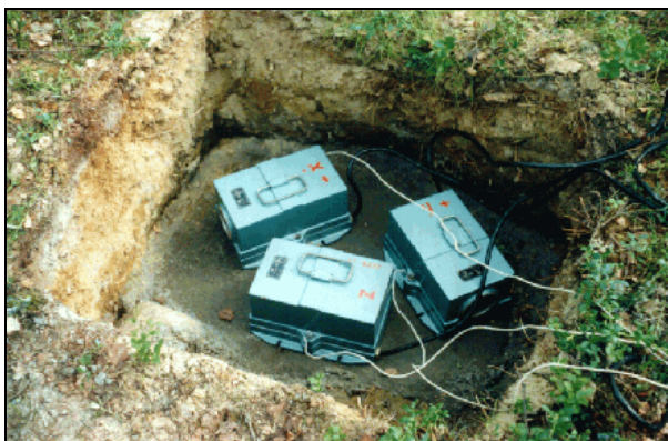
Рисунок 1. Установка сейсмоприемников СМЗ-КВ на предварительно подготовленной площадке
