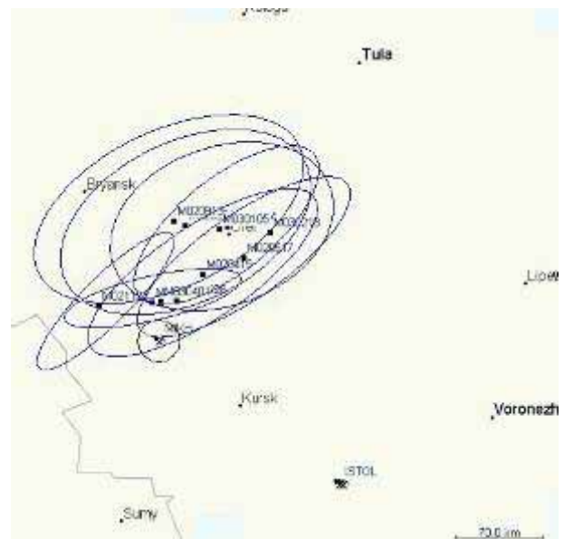
Рисунок 3. Пример локации событий на КМА средствами МСМ ( R_{mis} \sim 80 км, S \sim 13000 км 2 )
