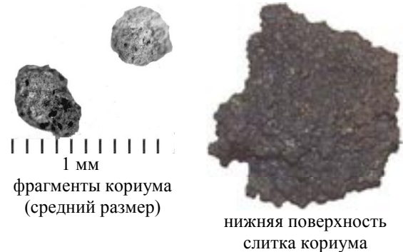
Рис. 6. Фото частиц и слитка кориума (A1)
