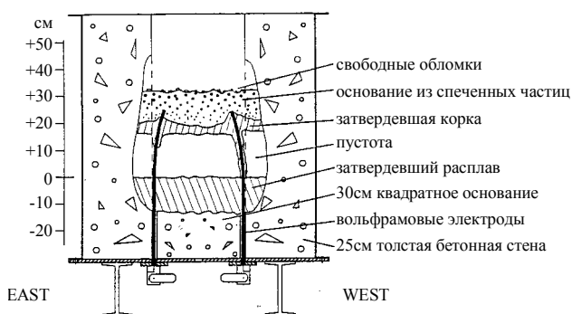
Рис.9 Геометрия продуктов МССИ и бетона в эксперименте МАСЕ-М0
