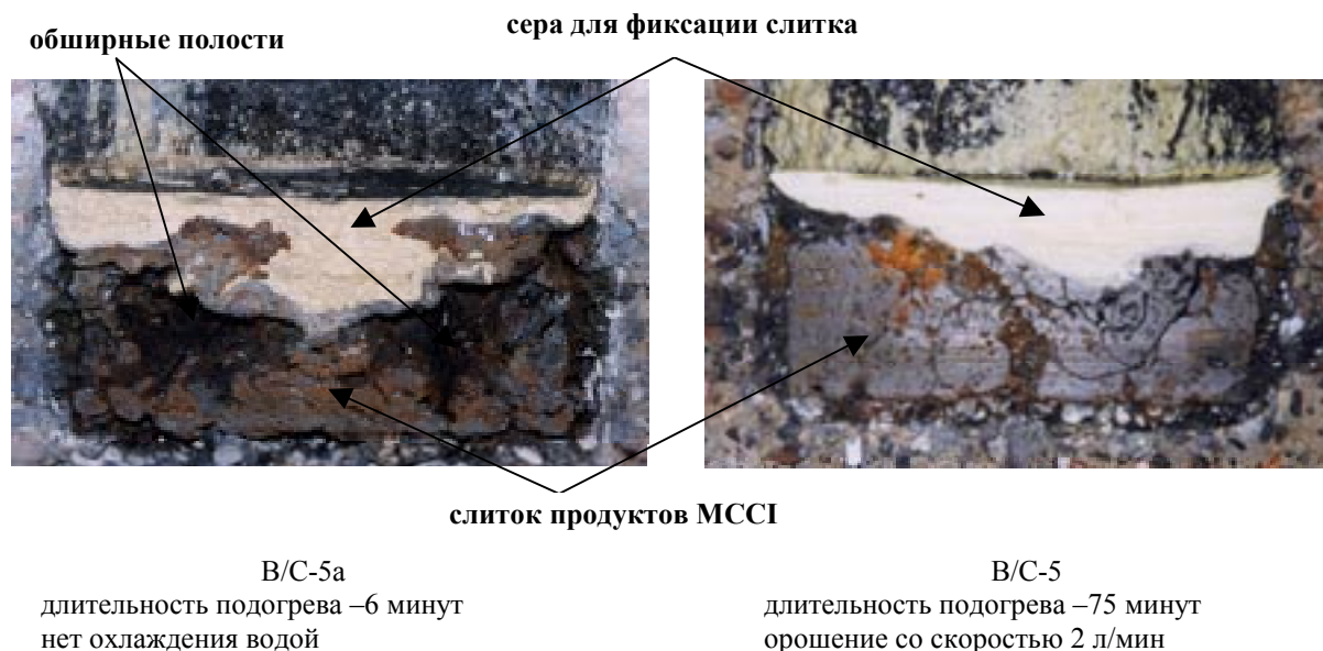
Рис.3. Подтверждение повторного расплава кориума в ловушке (В/С-5а и В/С-5)
