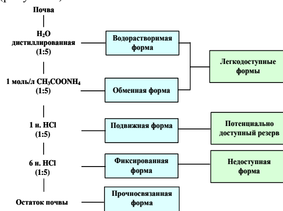
Рисунок 2. Схема последовательного выделения форм нахождения радионуклидов в почве
