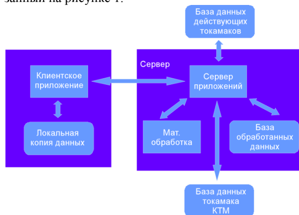
Рисунок 1. Архитектура системы преобразования и представления экспериментальных данных диагностик
