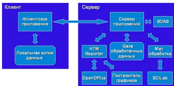
Рисунок 2. Схема архитектуры генератора отчетов KTMReporter
