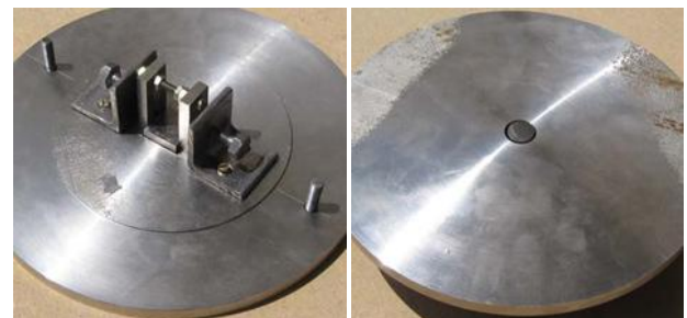
а – тыльная сторона мишени анодного узла для образца с рабочей поверхностью размером 20×20 мм; б – фронтальная сторона мишени анодного узла для образца с рабочей поверхностью диаметром 14 мм
