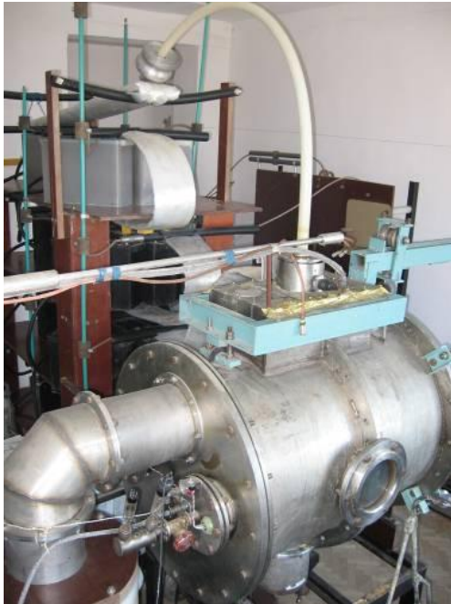
Рисунок 1. Внешний вид установки ГСЭП-3 (на переднем плане – вакуумный диод, на заднем – генератор импульсного напряжения (ГИН) конденсаторного типа)
