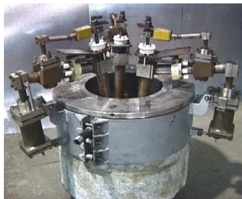
1 – электрод; 2 – модель днища; 3 – бетонная подставка; 4 – расплав; 5 – электродный узел.
