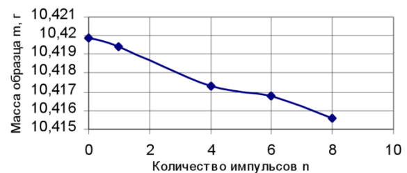
Рисунок 5. Изменение массы образца с увеличением количества импульсов электронного облучения (меж-электродный зазор 35 мм)
