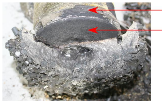
Рисунок 8. Внешний вид нижнего торца графитового наконечника внешнего электрода после удаления части кору́мы (стрелками показано отслоение карбидизированного покрытия)
