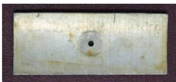
Рис. 6. Типичный внешний вид пассивированного (Al,Mg)-образца после 22,9 лет испытаний
