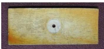
Рис. 7. Типичный внешний вид непассивированного (Al,Mg)-образца после 22,9 лет испытаний
