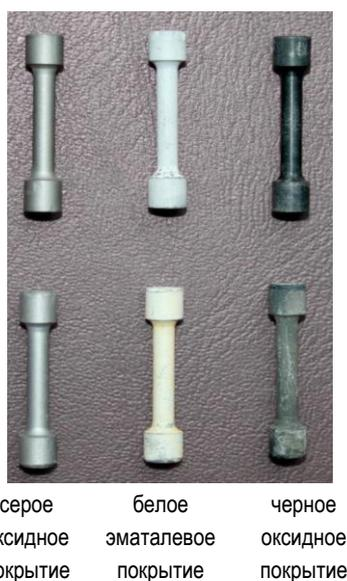
Рис. 2. Короткие (~28 мм) Be-образцы до (вверху) и после (внизу) 30,3-летних испытаний
