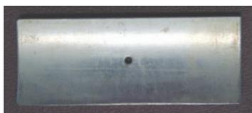
Рис. 5. Типичный внешний вид 12X18Н10Т-образца после 22,9 лет испытаний
