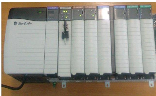
Рис. 2. Система управления ControlLogix 1756
