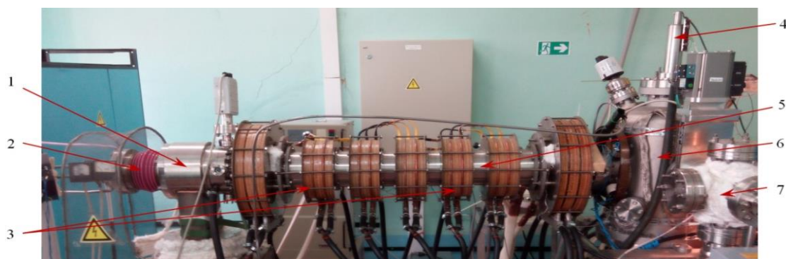
1 – камера ЭЛП; 2 – ЭЛП; 3 – электромагнитные катушки; 4 – зонд Ленгмюра; 5 – камера плазменно-пучкового разряда; 6 – камера взаимодействия; 7 – камера загрузки образцов.
