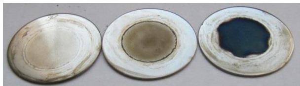
Рисунок 3 – Вид поверхности осаждаемого ^{242}\text{Pu} в зависимости от силы тока; соответственно слева направо 800 мА, 1200 – 1400 мА, 2000 мА
