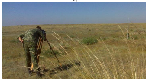
Рисунок 4 – К проведению нивелирования II класса по реперам: а – цифровой нивелир SOKKIA SDL 30 №10271; б – работа с нивелиром
