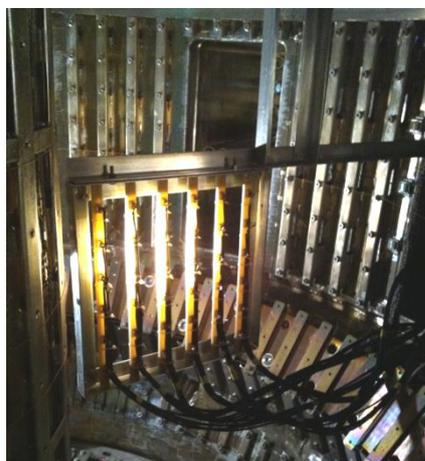
Рисунок 5. Размещение матрицы датчиков Холла внутри ВК КТМ
