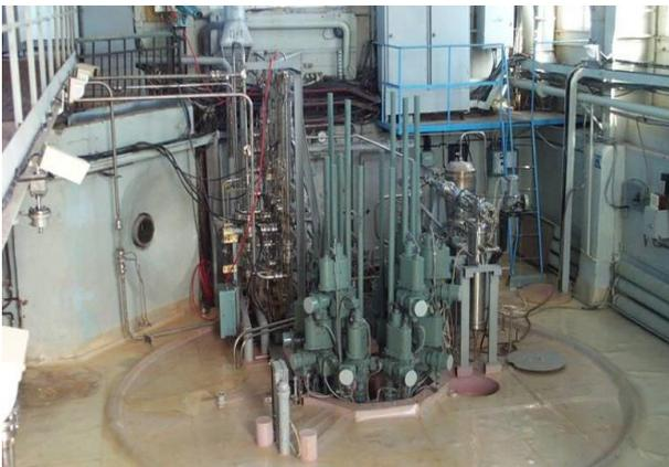
Рисунок 1. Импульсный графитовый реактор
