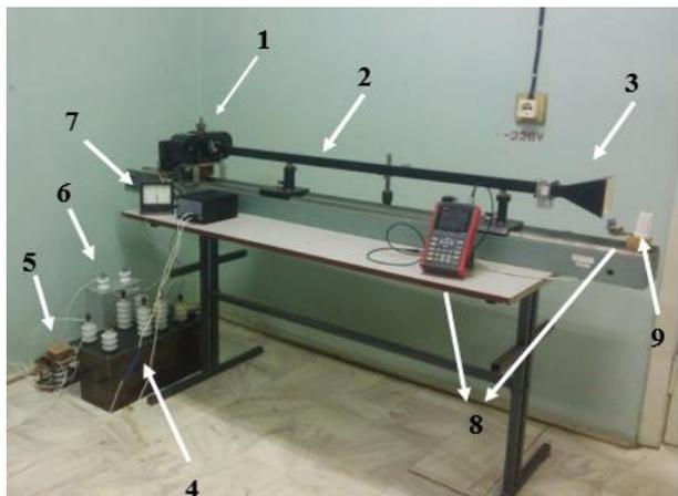
1 – магнетрон МИ-99 А, 2 – волновод, 3 – рупорная антенна, 4 – повышающий трансформатор, 5 – высоковольтный тиристорный ключ, 6 – конденсатор, 7 – амперметр, 8 – датчик СВЧ, 9 – люминесцентная лампа.
