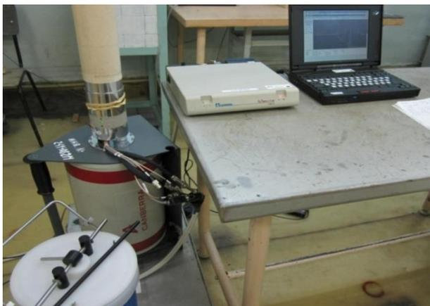
Рисунок 4. Гамма-спектрометрический комплекс
