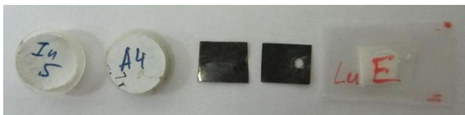
Рисунок 1. Активационные индикаторы для определения характеристик поля нейтронов
