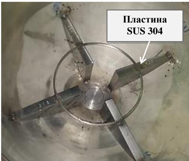
Рисунок 2. Общий вид дна ловушки расплава до эксперимента, с установленными и закрепленными пластинами
