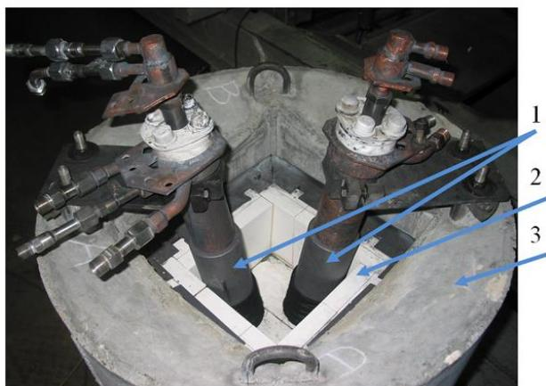
1 – плазматроны; 2 – огнеупорные блоки; 3 – бетонная ловушка
