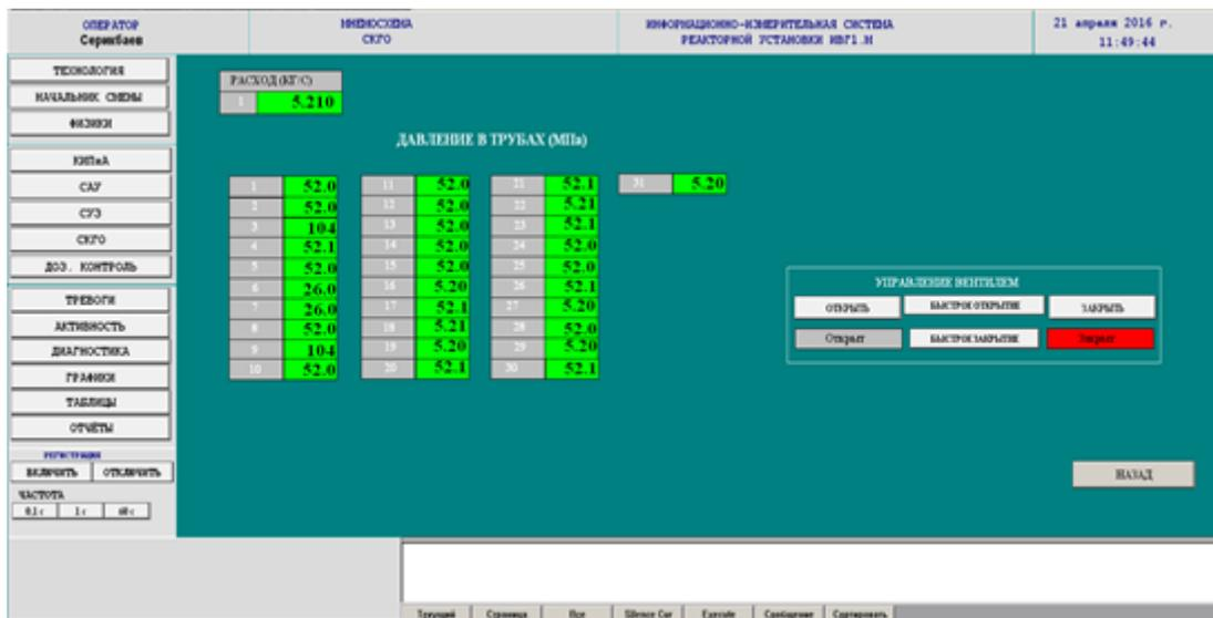
Рисунок 14. Мнемосхема СКГО (датчики давления)
