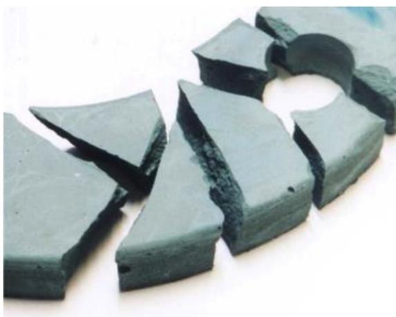
Рисунок 1. Макет топливной детали гипотетического исследовательского реактора, разбитый на фрагменты
