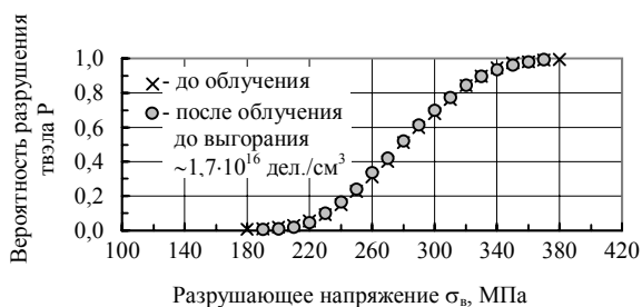
Рисунок 1. Кумулятивные кривые вероятности разрушения ((U,Zr,Nb)C) -твэлов до и после 5-часового облучения в ампуле РА-24
