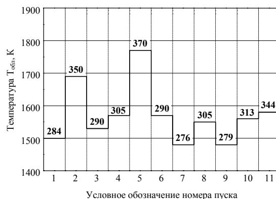
Рисунок 7. Характер изменения температуры ТВЭлов при испытаниях в 11 пусках РА2-19, ..., РА3-9 (указаны максимальные значения T_{обл} у ТВЭлов ампул второго кольцевого ряда)
