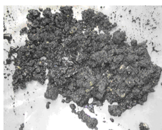
Рисунок 28. Фрагменты расплава окиси алюминия после взаимодействия с жидким натрием
