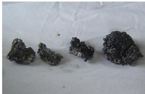
Рисунок 31. Фрагменты расплава, извлеченные из ловушки расплава
