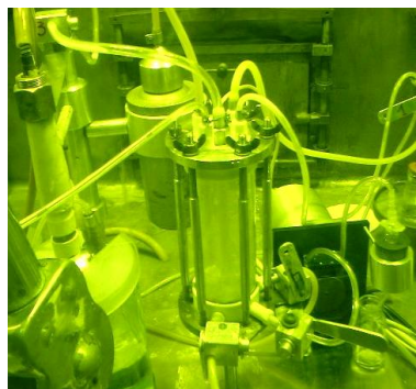
б – Установка для получения препарата Тс-99м в горячей камере
