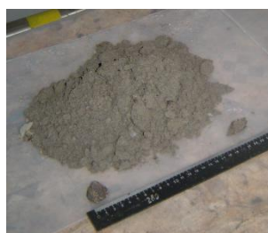
Рисунок 28. Фрагменты расплава окиси алюминия после взаимодействия с жидким натрием
