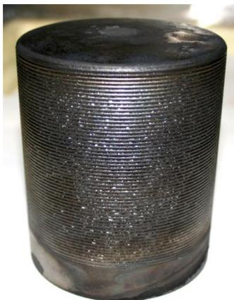
Рисунок 2. Наконечники электродов плазматронов с покрытием из карбида циркония
