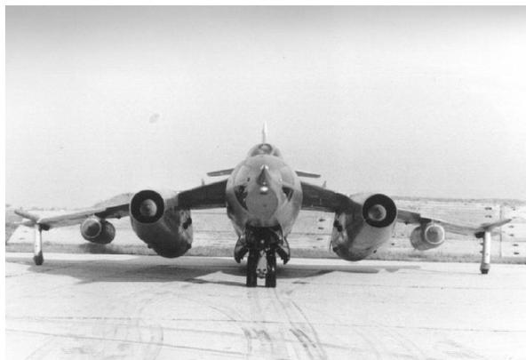
д – сверхзвуковой самолёт-заборник, оснащённый фильтрогондолами
