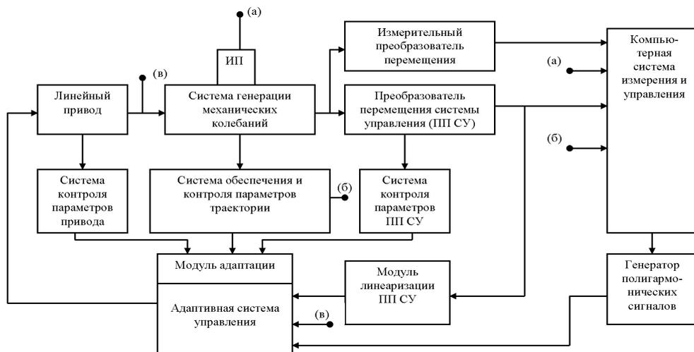
Рисунок 4. Принципиальная схема эталонных установок
