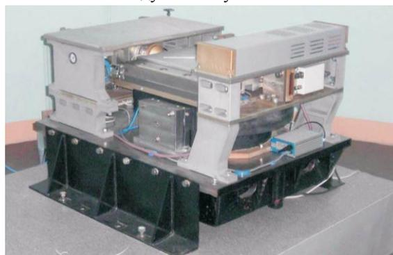
Рисунок 5. Электромеханическая система установки УСГ-3М – прототипа эталонной установки для воспроизведения параметров горизонтальных сейсмических колебаний
