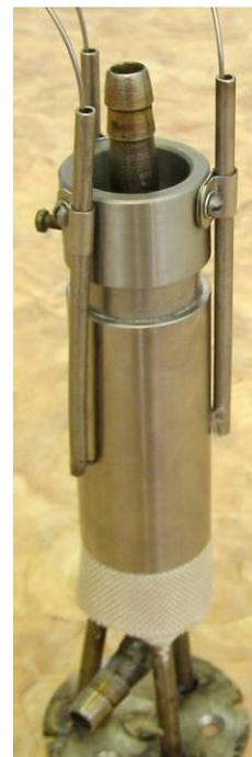
Рисунок 1. Схема калориметрической сборки (а), внешний вид калориметра (б)
