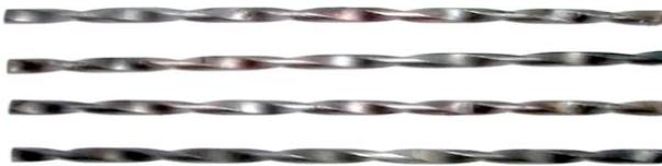
Рисунок 1. Внешний вид стержневых керамических твэлов реакторов ЯРД, ЯЭДУ и ЯГДУ
