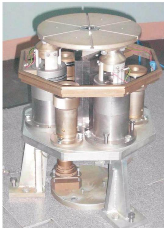
Рисунок 6. Установка УСВ-2 - прототип эталонной установки для воспроизведения параметров вертикальных сейсмических колебаний
