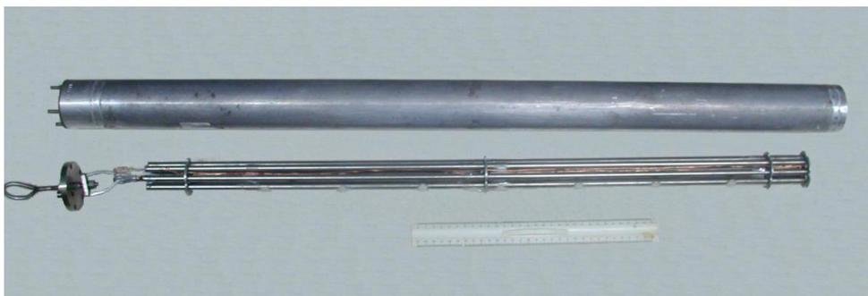
Рисунок 7. Внешний вид ТВС и корпуса ФМ ТК
