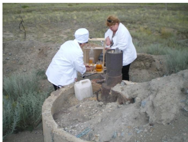
Рисунок 4. Площадка «Балапан». Отбор проб газа из скважины
