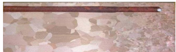
Рисунок 9. Макроструктура бронзы во втором макете ПС (периферия макета слева)
