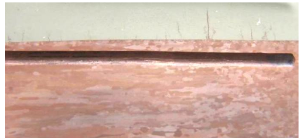
Рисунок 4. Макроструктура бронзы в первом макете ПС (периферия макета слева)
