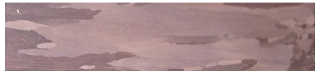
Рисунок 12. Макроструктура бронзы в третьем макете ПС (периферия макета слева)
