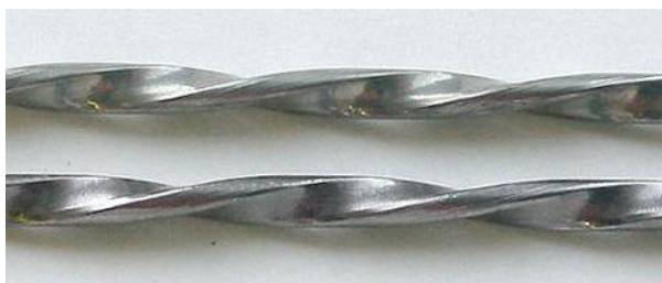
Рисунок 3. Внешний вид облученного (вверху) и исходного (внизу) твэлов реактора ИВГ.1М
