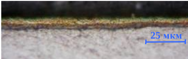
Рисунок 10. Микроструктура бериллия в третьем макете ПС вблизи поверхности разрушения (после травления)
