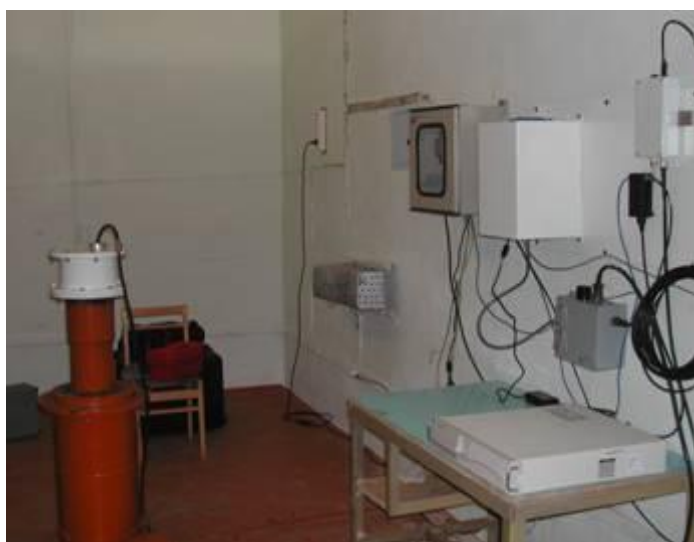
Рисунок 5. Станция AS059-Актюбинск: приборное сооружение (слева - оголовок скважины, в которой установлен сейсμοприемник, справа - электронная часть оборудования); монтаж антенны
