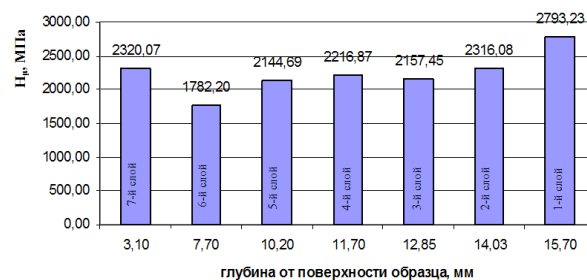
Рисунок 3. Микротвердость металла шва по слоям сварного соединения (сварка длинной дугой I_{св} (ср) = 150-155 А, I_{св} (имп) = 520-530 А, U_d = 30 В, \nu = 50 Гц)
