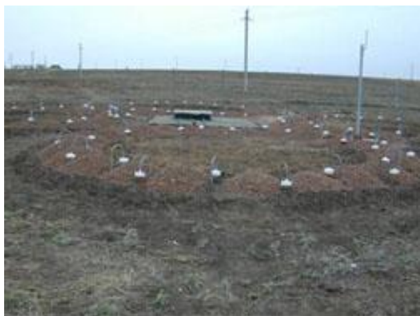
Рисунок 7. Станция IS31-Актюбинск: конфигурация элементов инфразвуковой группы, центральный пункт
