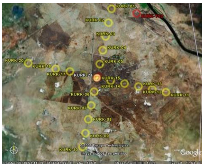
Рисунок 6. Станция AS058- Курчатов: техническое здание конфигурация сейсмической группы
