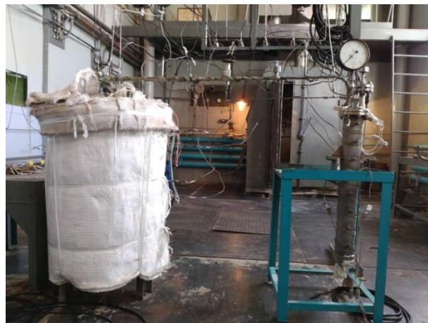
Рисунок 9. Общий вид схемы эксперимента (трубопровод и экспериментальная ёмкость без теплоизоляции)
