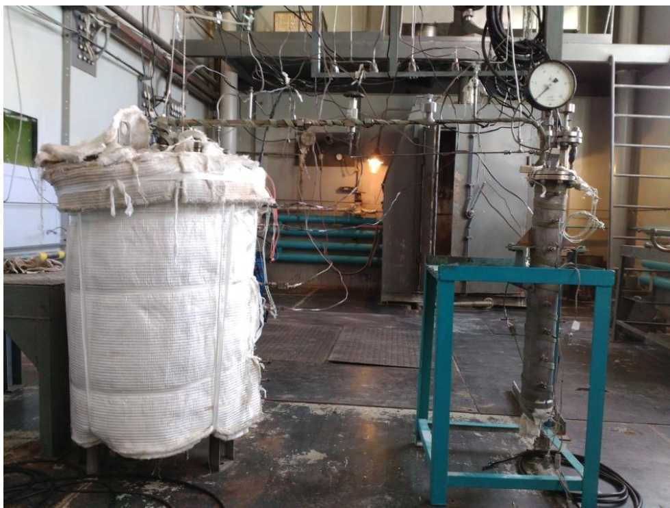
Рисунок 5. Общий вид схемы эксперимента (трубопровод и экспериментальная ёмкость без теплоизоляции)
