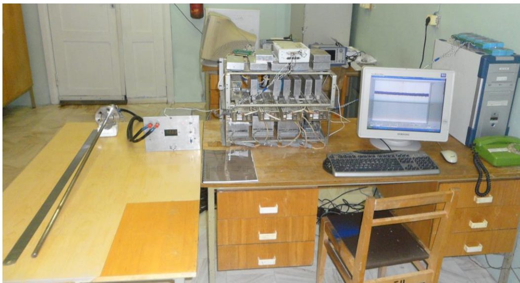
Рисунок 3. Локальная система измерения параметров жидкого натрия в сборе
