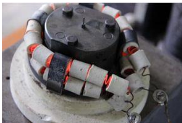
Рисунок 2. Внешний вид матрицы «Shear Punch» в керамическом нагревательном кольце
