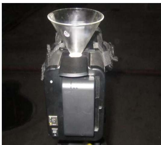
Рисунок 2. Тепловизор IRTIS-2000, охлаждаемый жидким азотом
