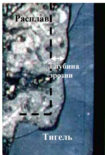
Рисунок 4. Область эрозии графитового тигля с покрытием из карбида ниобия, нанесенным методом газозащитного осаждения
