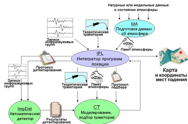
Рисунок 7. Структура программного комплекса инфразвуковой локации
