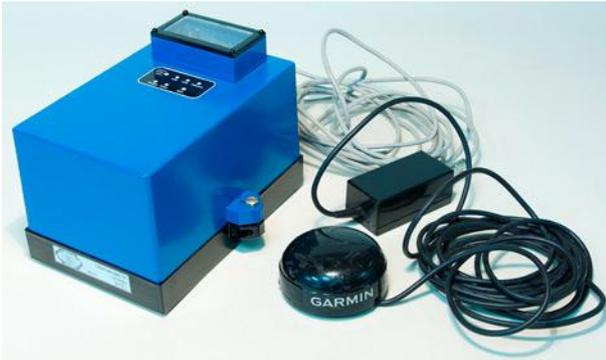
Рисунок 1. Портативный цифровой сейсмометр ПЦС с приёмником GPS
