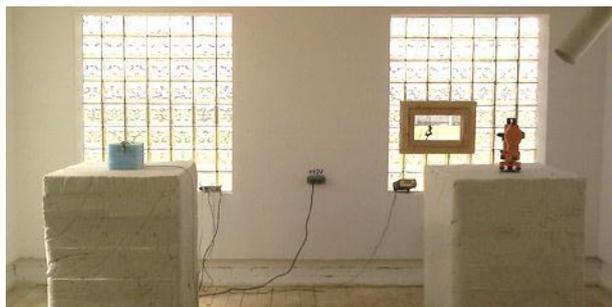
Слева – постамент для измерений модуля магнитного поля (POS-1), справа – постамент для DI-измерений (LEMI-204). Над DI-постаментом установлена специальная монтировка, обеспечивающая астрономические наблюдения Полярной
