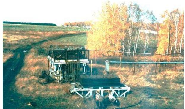
Рисунок 1. Вибраторы ЦВ-40 (ближний) и ЦВ-100 на Быстровском вибросейсмическом полигоне СО РАН
