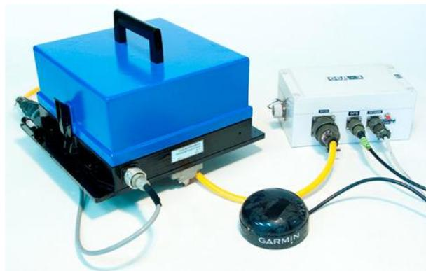
Рисунок 11. Внешний вид ПЦСС с трёхкомпонентным велосиметром ТС-5 и приёмником GPS
