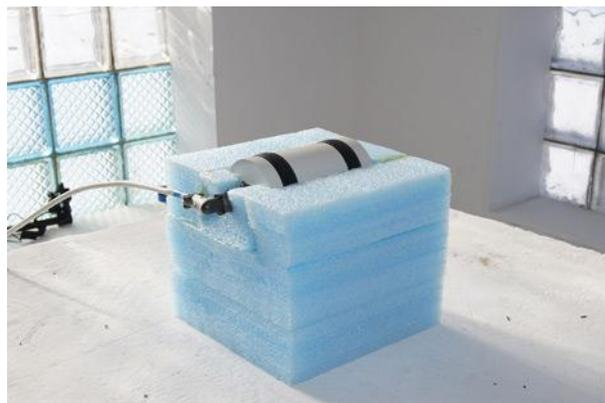
б – датчик оверхаузеровского магнитометра POS-1
