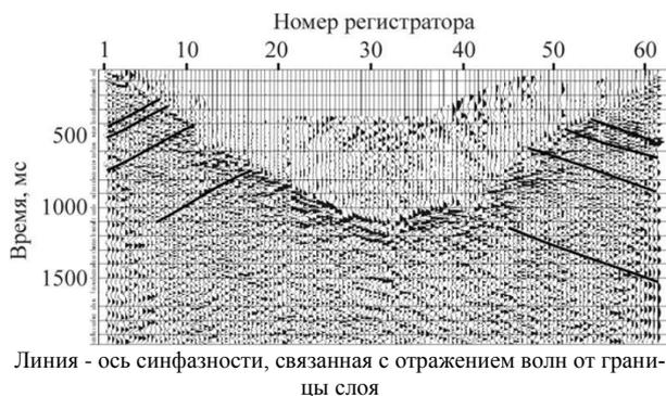
Рисунок 4. Профиль П1. Совмещенный глубинный временной разрез, построенный от источников Т8, Т1 по методу однократного ОГТ
