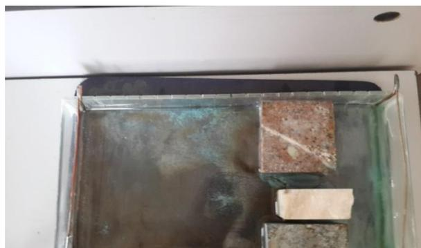
Рисунок 4. Отложение гидроокиси меди на дне кюветы после узких протоков
