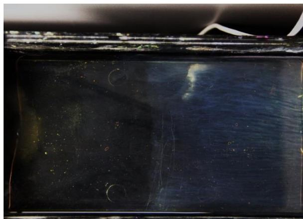
Рисунок 4. Образование каналов в растворе электролизной ячейки
