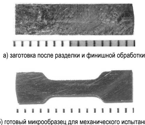
Рисунок 2. Изображение микрообразца на различных этапах его изготовления
